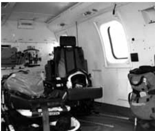
Fig. 3 Kabinen er designet for ambulansetransport. Utstyret er standard ambulansetrustning med Corpuls monitor med ikke-invasiv BT-måling, SaO 2 , endetidal CO 2 , defibrillator, temperatur, 4 avlednings-scoop, og 12 avlednings-EKG som kan overføres til sykehus/vaktlege. Foto: SAR HNO
